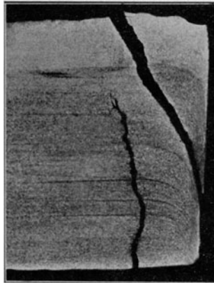
Abb. 67. Querschnitt durch ein gestanztes Nietloch. V' = 4 .
