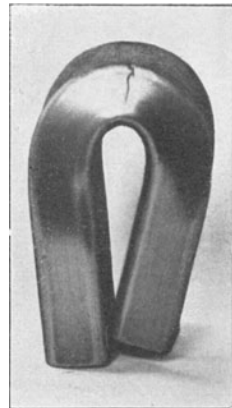
Abb. 14. Blech Nr. 2. Hartbiegeprobe.
