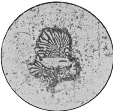
Abb. 245. Aus Stück M_1 , Schnitt parallel zur Walzhaut. V = 300 .
