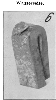
Abb. 231. Warmbiegeprobe, senkrecht zur Kesselachse, aus dem Scheitel.
