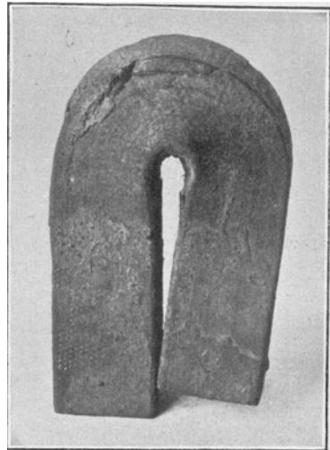
Abb. 91. Wasserseite. Warmbiegeprobe, Stab 7.
