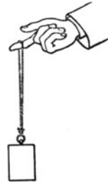
Abb. 68. Veranschaulichung der Kraft zum Beschleunigen einer Last beim Anheben.
