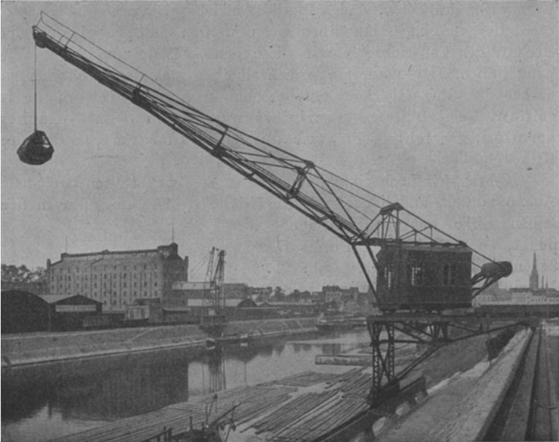
Abb. 10. Drehkran nach üblicher Ausführung (vgl. Abb. 11). (Ausführung der Duisburger Maschinenfabrik Jaeger G. m. b. H., Duisburg.)
