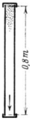
Abb. 79. Einfaches Verfahren zur Bestimmung der bei der Vernichtung von Energie erzeugten Wärme.
