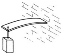
Abb. 129. Biegung eines flach gelegten Brettes.
