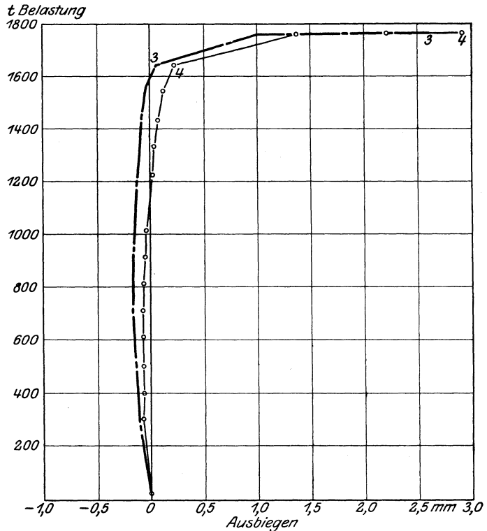
Fig. 14. Beobachtungen an den Meßpunkten 3 u. 4. Senkrechtcs Ausbiegen.
