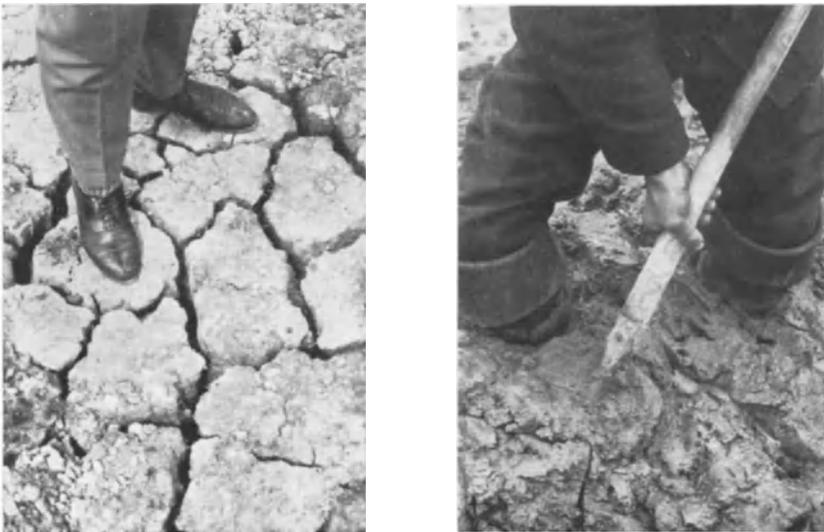
Abb. 47. Bindiger Boden a) in trockenem, b) in nassem Zustand.
