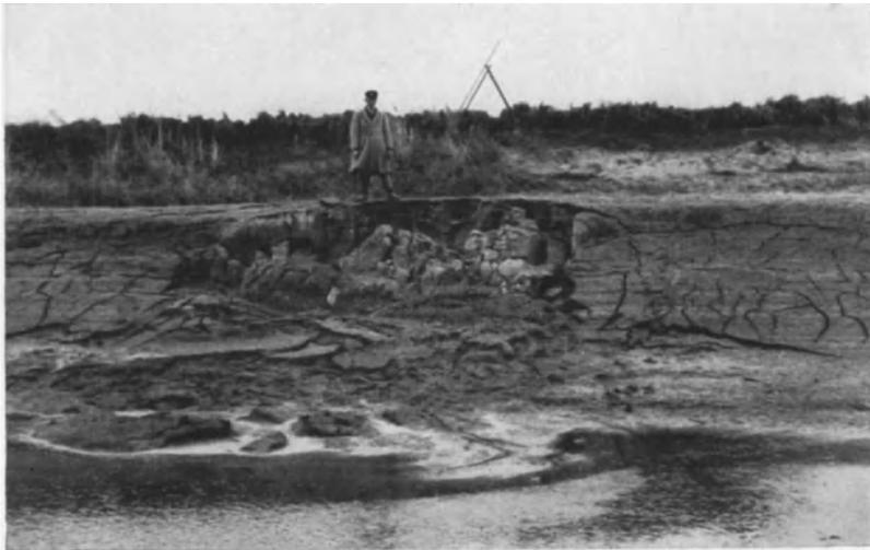
Abb. 48. Rutschung an einer bindigen Böschung nach dem Abspumpen.
