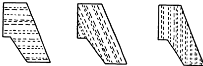
Abb. 383. Hakensteine, gut (links) und schlecht (Mitte und rechts) angearbeitet
