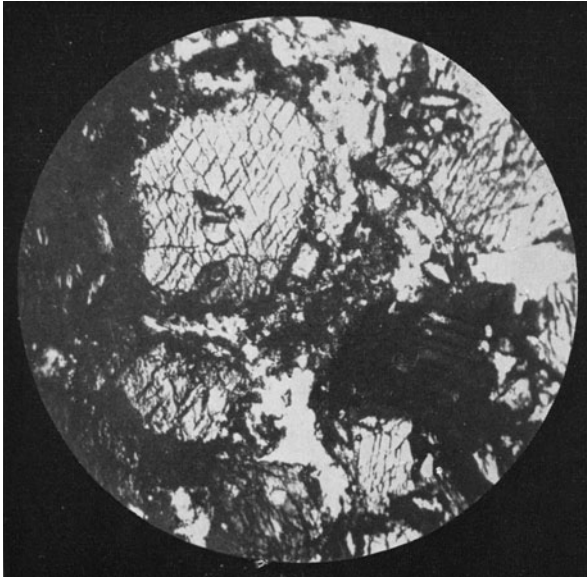
Abb. 91. Hornblende (hell) mit Spaltrissen, die sich unter einem Winkel von 124\frac{1}{2}^\circ kreuzen. Amphibolit von Mixnitz, Steiermark
