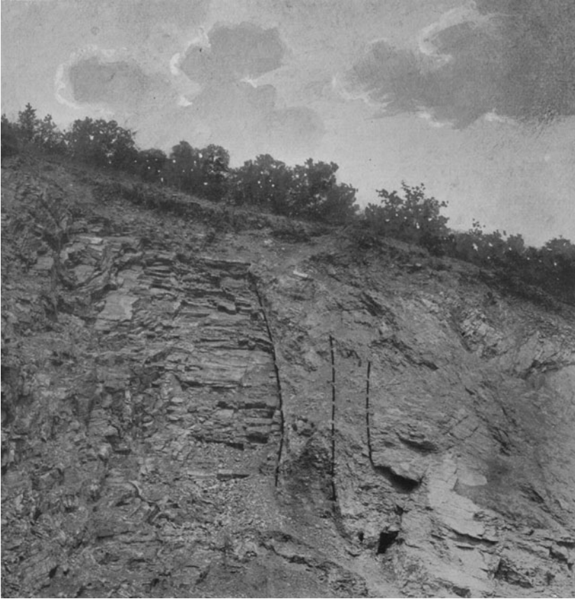
Abb. 331. Verwerfungen (gestrichelte Linien) und ihnen annähernd gleichlaufende Klüfte. Steinbruch bei Gießhübl, N.-Ö.
