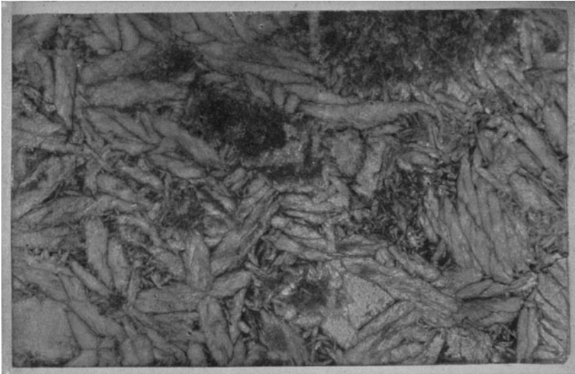
Abb. 190. Talkspat. Sunk bei Trieben. Flache Rhomboeder pignollenähnlich in einem Tonschieferteile liegend (Pinollit)
