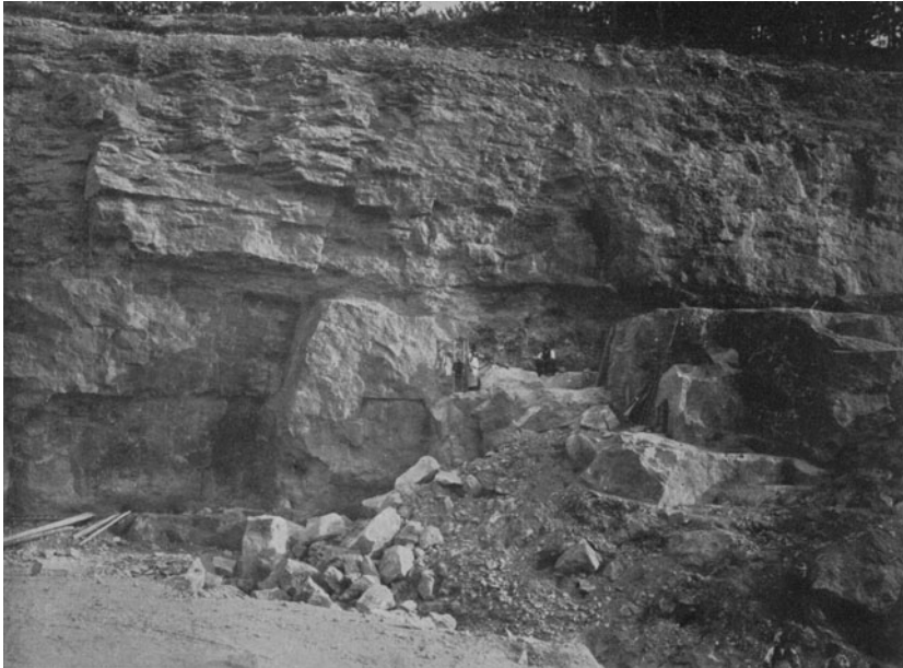
Abb. 180. Erleichterung der Steingewinnung durch Schichtklüfte und Steilklüfte im tertiären Leithakalk des Rauchstallbrunngrabens bei Baden, N.-Ö.
