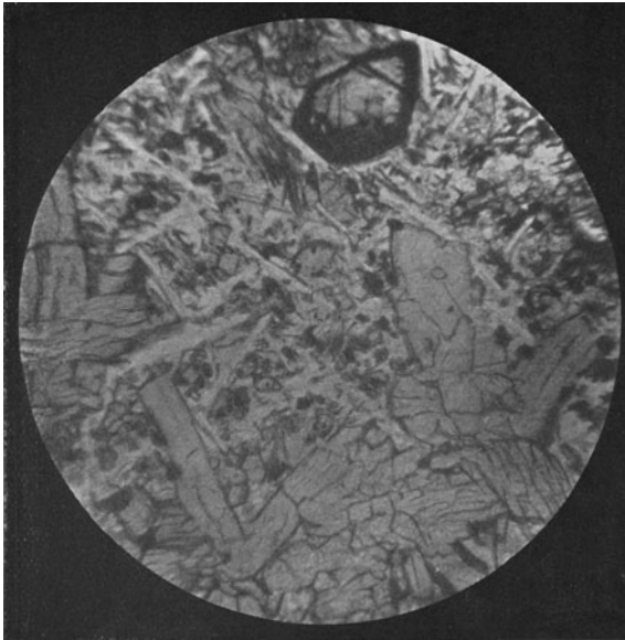
Abb. 136. Verschränkter Verband. Augit (breite Säulen), Plagioklas (schmale, helle Leisten), Olivin (dunkel umrandet); Basalt vom Steinberge bei Felzbach, Oststeiermark
