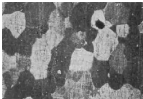
Abb. 23. Reines \beta -Gefüge im Ms 58 (abgeschreckt).
