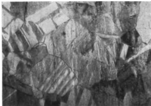
Abb. 21. Rekristallisationsgefüge von Ms 85. × 100
