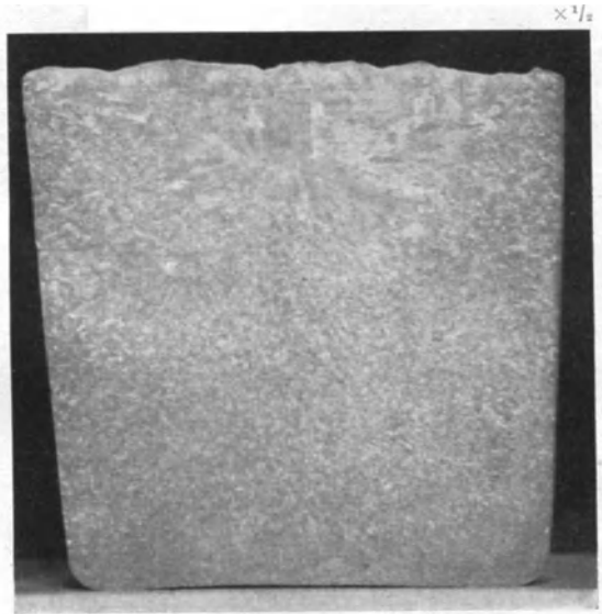
Abb. 5. Kupferbarren mit feinkörnigem Gefüge.
