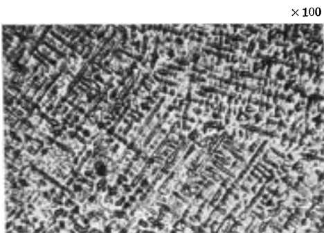
Abb. 48. Gußgefüge einer Sn-Bronze G-Bz 10 (Schichtkristalle).
