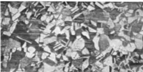
Abb. 30. Feinkörniges \alpha -Messing mit glatter Tiefungsprobe.
