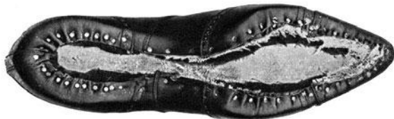
Abb. 1. Sohlenseite eines durchgenähten (Mac-Kay-) Schuhs.
