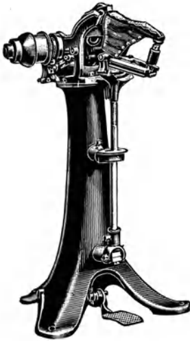
Abb. 2. Anklopfmaschine der „United“ von 1905.
