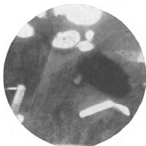
Abb. 28. Pleochroitische Höfe um Zirkone in Biotit; man beachte die Verschiedenheit des Gehaltes an Radioaktivität; Vergr. ca. 125 \times .
