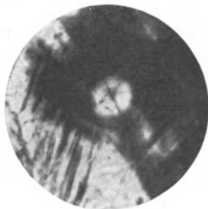
Abb. 44. Ausgebleichter Hof in ursprünglich gefärbtem Flußspat; etwa den positiven Hofen Abb. 38 und 39 entsprechend; Vergr ca. 160×.
