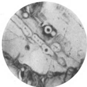
Abb 45 und 46. Wo die aktiven Kerne in Reihen liegen, verwachsen die Höfe miteinander und schließlich zeichnet sich nach eingetretener „Solarisation“ nur noch die gemeinsame Einhüllende ab; Übergang zu Ausbleichungszonen, die mit aktivem Material gefüllte Spalten begleiten; Vergr. ca 50×.
