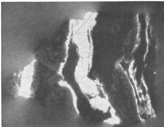
Abb. 2. Wirkung dieses Gangstückes. 3 Tage auf eine photographische Platte getegt; die hellen Teile sind die bestrahlten.
