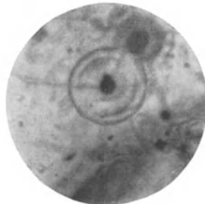
Abb. 42. Intensive zweite Verfärbung vom Kern ausgehend; alle Ringe ausgebleicht außer dem RaC-Ring, der schon doppelt ist.
