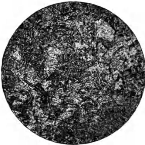
Abb. 14. Werkzeugstahl mit 0,89% Kohlenstoff nach dem Abschrecken; feines nadelförmiges Gefüge (Martensit). (Aus Brearly-Schäfer, Werkzeugstahl 3. Aufl.)
