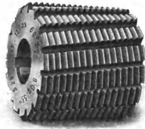
Abb. 63. Walzenförmiger Gewindefräser (Wanderer-Werke, Chemnitz).
