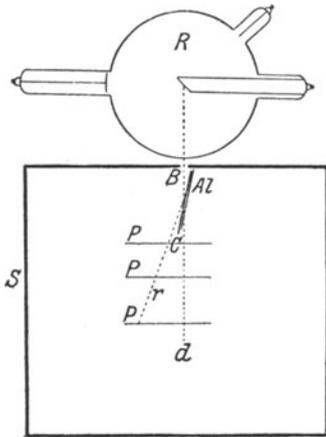
Abb. 12. Röntgenspektrograph nach *Bragg*. *R* Röntgenrohr, *B* Blende, *C* Kristallplatte, *Al* Kristallträger, *P P P* photographische Platten, *S* Schutzkasten, *d* durchgehender Strahl, *r* reflektierter Strahl.
