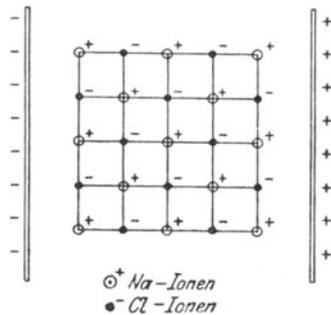
Abb. 3. Steinsalzgitter im elektrischen Felde.
