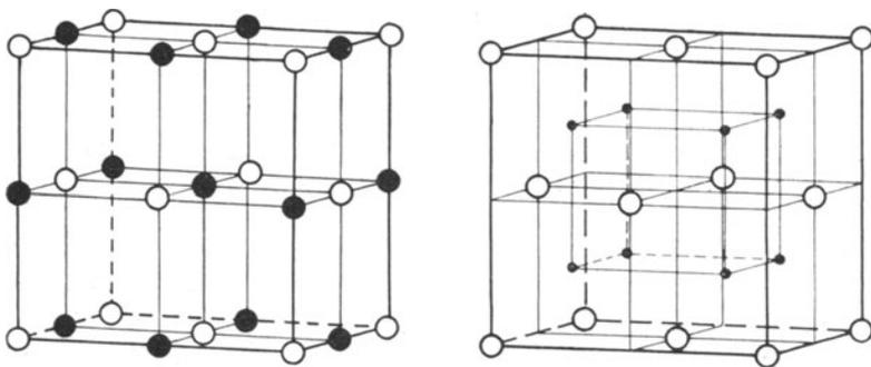
Abb. 7. Gitter des Steinsalzes (NaCl) und des Flußspats (CaF<sub>2</sub>).
