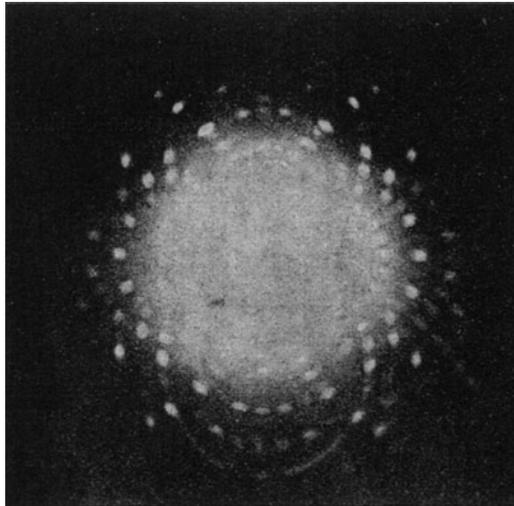
Abb. 9 und 10. Röntgenstrahlinterferenzen nach *Laue*.
