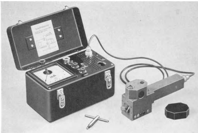
Abb. 175. Einkomponenten-Schnittkraftmesser und Anzeigegerät (Ausführung Siemens & Halske A.G.).
