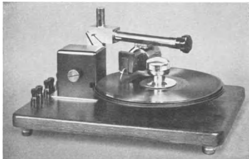
Abb. 118. Bolometrisches Abtastgerät für Schallplatten.
