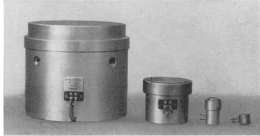
Abb. 172. Kohle-Druckmeßdosen für 1000; 100; 10; 0,1 t Meßbereich (Ausführung Rumpff, Bonn). (Aus Rumpff-Druckschrift 750—2.)
