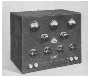
Abb. 9. Röhrenregler der Siemens & Halske A.G. [Aus Siemens-Z. Bd. 12 (1932) S. 428–43.]
