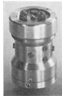
Abb. 216. Kohledruck-Beschleunigungsmesser der Siemens & Halske AG.
