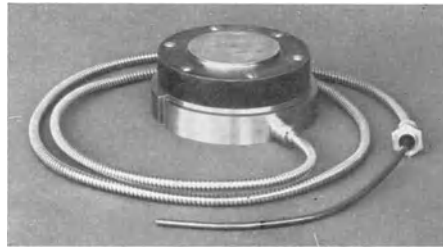
Abb. 168. Kapazitive Druckdose mit Biegeplatte für 100 t (Ausführung Siemens & Halske AG.).
