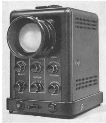
Abb. 272. Tragbarer Elektronenoszillograph von Siemens & Halske.
