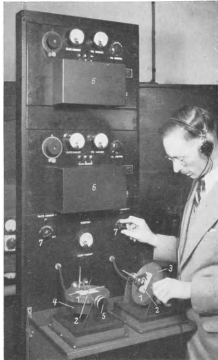
Abb. 284. Akustische Zeitwaage amerikanischen Ursprungs (Bell Telephone Laboratories). (Aus Arch. techn. Messen J 154—9.)
