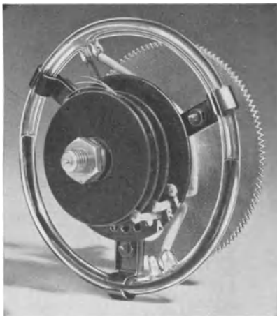
Abb. 59. Ringrohr-Widerstandssender in Potentiometerschaltung. (Ausführung Siemens & Halske AG.)
