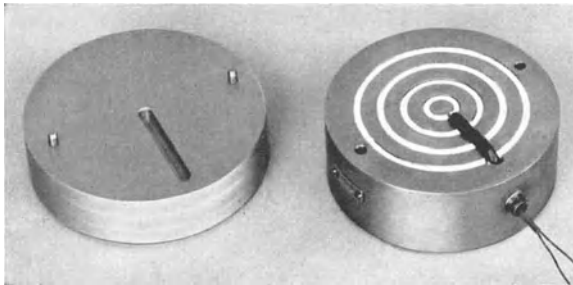
Abb. 165. Magnetoelastische Druckdose für 100 t. (Aus Arch. techn. Messen V 132—15.)
