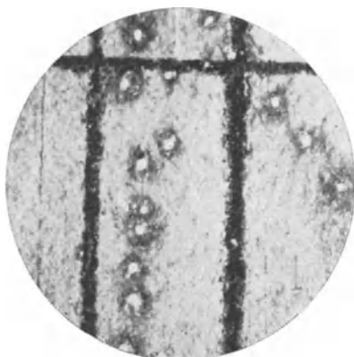
Abb. 253. Mikrophotographie von Funkenmarken auf Wachspapier.
