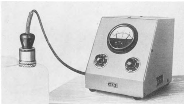
Abb. 138. Ansicht eines induktiven Schichtdickenmessers. (Aus AEG-Mitt. 1939 S. 192.)
