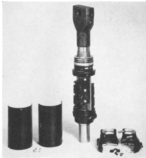
Abb. 162. Kapazitiver Verdrehungsmesser von Siemens & Halske, Bürstenhalter und Schutzhaube abgenommen. (Aus Arch. techn. Messen V 136—2.)
