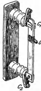
Fig. 240. Momenthebelschalter für Schalttafelrückseite mit Griff vorne. Fig. 241. Einfacher Trennschalter.
