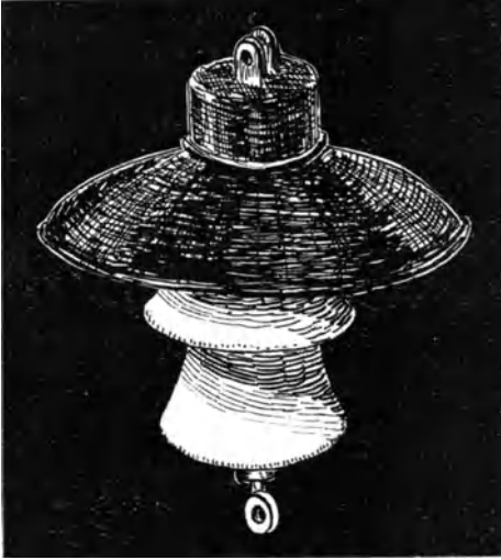
Fig. 272. Deltaglocke als Hängeisolator.
