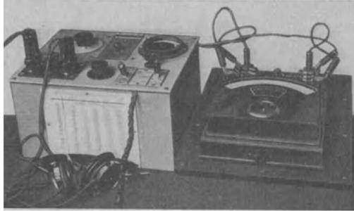
Abb. 78. Ansicht des Röhrevoltmeters von Klotz.
