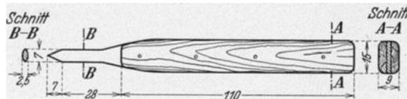
Abb. 250. Messer zum Drähteeinziehen.
