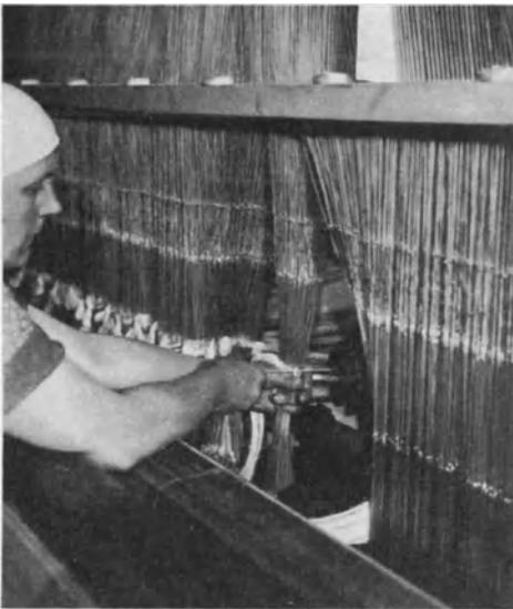
Abb. 81. Einziehen der Kettenfäden in den Harnisch.
