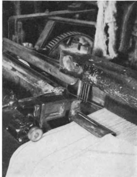
Abb. 123. Im Webstuhl eingebauter Breithalter und Meterzähler der Firma Irion & Vosseler, Schwenningen a. N.
