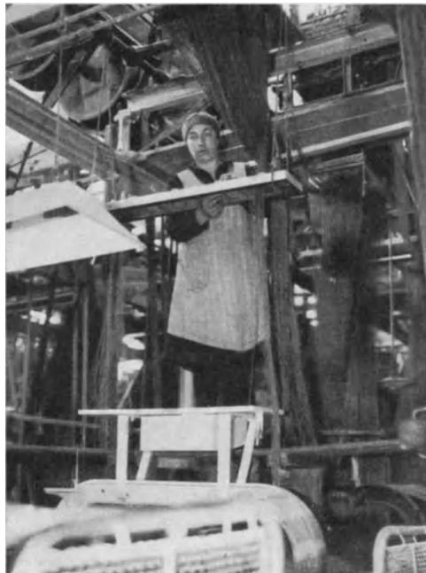
Abb. 217. Einziehen der Harnischschnüre durch das Chorbrett.
