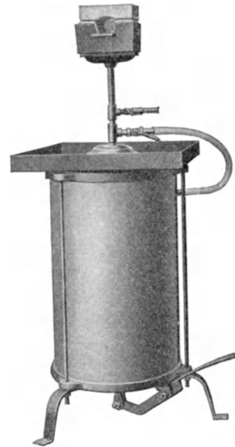
Abb. 2. Kleiner Gashärteofen mit Gebläse für Schnelldreh- und Hobelstähle.
