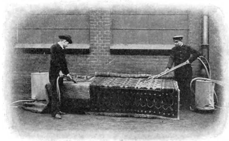
Abb. 23. Wirkungsweise des Druckluftsaugers.
