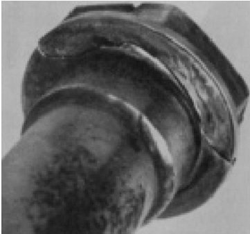
Abb. 69. Dauerbruch am Schraubenkopf, begünstigt durch Reibkorrosion.
