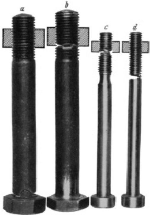
Abb. 64. Dauerbrüche zugwechselbelasteter Schrauben bei unsauber ausgeführter (a) und guter Kopfausrundung (b), bei schlecht nachgerolltem Gewindeauslauf (c) und Gewinderille zum Auslauf der Druckrolle (d).
