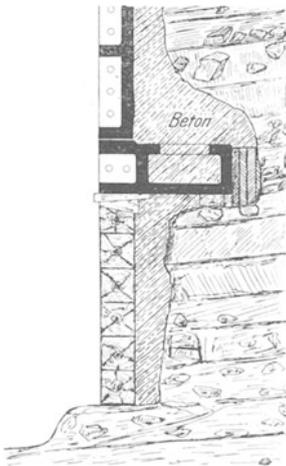
Fig. 133. Verlagerung des Keilkranzes im schwachen Gebirge. (Aus Riemer, Das Schacht-abteufen.)
