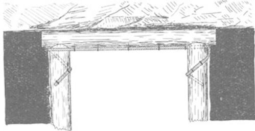
Fig. 254. Kappe mit untergespanntem Seil.
