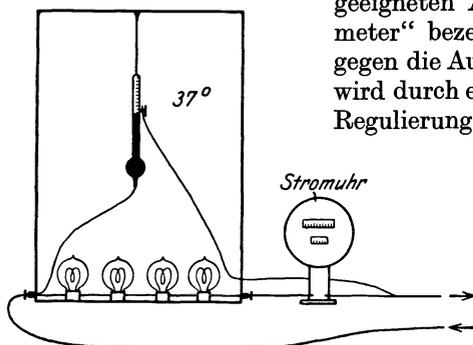
Abb. 17. Prinzip eines Apparates zur fortlaufenden calorimetrischen Messung der auf  $37^{\circ}$  bezogenen abkühlenden Wirkung des Wetters (nach H. SCHADE).
