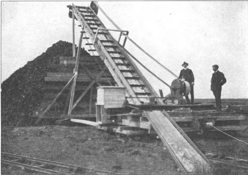
Abb. 44. Kratzer zum Häufeln von Torf.
