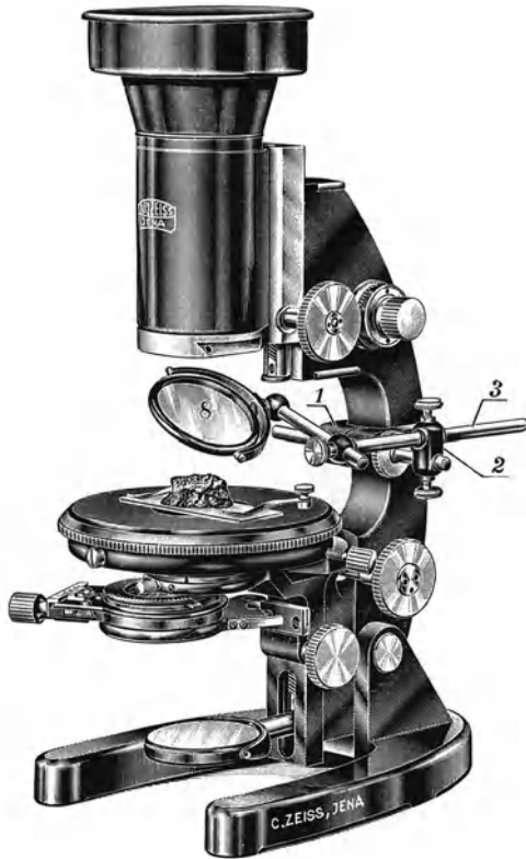
Abb. 127. Beleuchtungseinrichtung für steil auffallendes Licht mit einer planparallelen Glasplatte (8) auf Haltern (1, 2, 3). (Aus ZEISS-Druckschrift: Mikro 401.)
