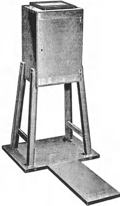
Abb. 85. Die Vertikalkamera nach VAN HEURCK der Firma WATSONS & SONS. (Aus der Druckschrift der genannten Firma: Photomicrographic and Projection Instruments, 32. Ed.)
