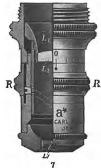
Abb. 10. Schwaches Objektiv (ZEISS Obj. a*) mit veränderlicher Vergrößerung.
