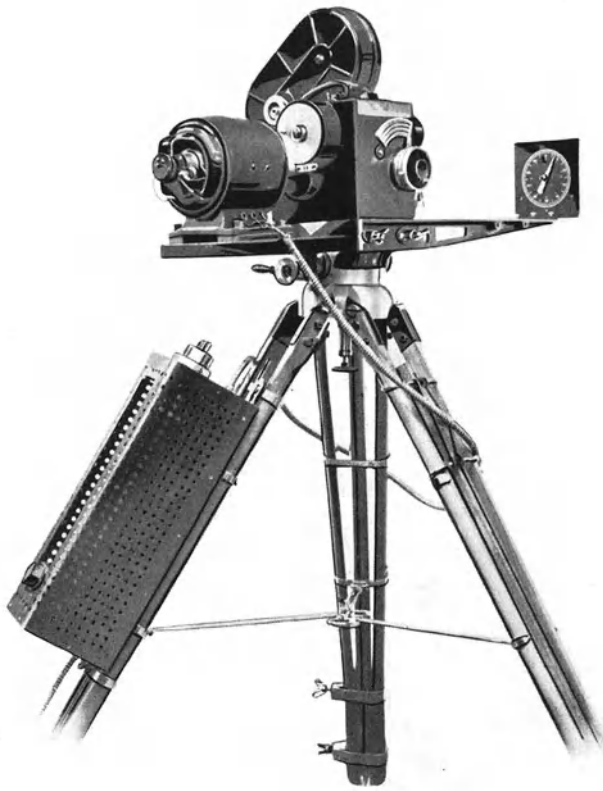
Abb. 233. Hochfrequenzberufskamera („Grande vitesse DEBRIE“) in waagerechter Stellung mit elektrischer Uhr zur Zeitmarkierung. (Aus K. HÖFER [I, Abb. 132, S. 465].)
