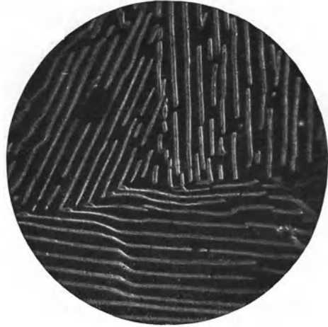
Abb. 143. Lamellarer Perlit. Vergr. 940fach. (Aus F. HAUSER [5].)
