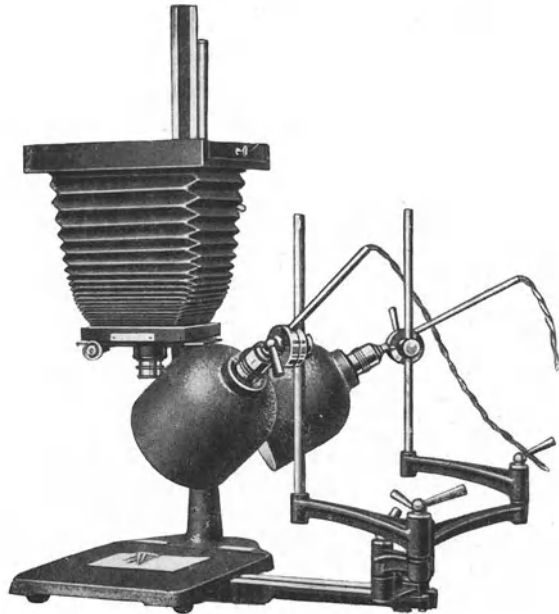
Abb. 119. Einrichtung für Beleuchtung opaker Gegenstände der Firma E. LEITZ. (Aus LEITZ-Druckschrift Nr. 51 G. d.)
