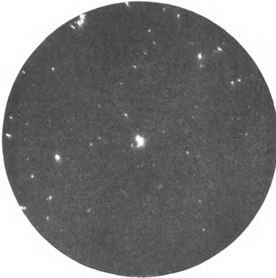
Abb. 102. Ultramikroskopisches Bild. Rußteilchen, deren Größenordnung nach Auszählung und Berechnung (PERRINSche Methode) zwischen 15 und 40 m\mu liegt, in Gelatine suspendiert (vgl. S. 217). Hom. Imm. ZEISS-Obj. 60fach, num. Ap. 0,85, Komp. Ok. 15fach, Kammerlänge: 41 cm, Bildvergr. 970fach. Paraboloid-Wechselkondensator, Belichtungszeit 2 1/2 Min.
