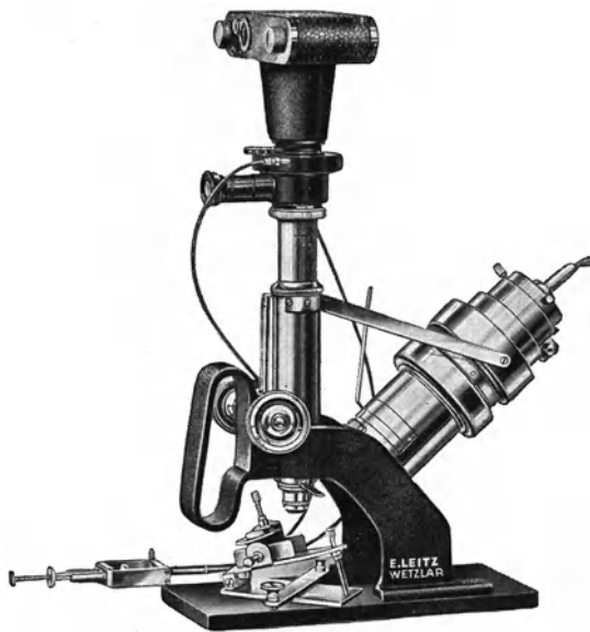
Abb. 123. Mikrophotographische Einrichtung der Firma E. LEITZ zur Kapillarmikroskopie mit der „Mifilmca“.
