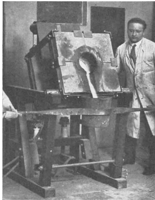
Abb. 210. 50-kg-Schmelzofen mit 10 000 Hz.
