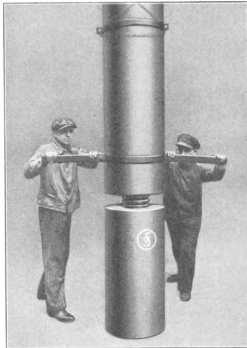
Abb. 82. Zusammenschrauben von Elektroden mit losem zylindrischem Nippel.
