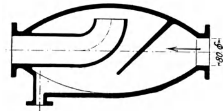
Abb. 72. Abscheider, durch Schleuderkraft mittels Richtungswechsels wirkend.
