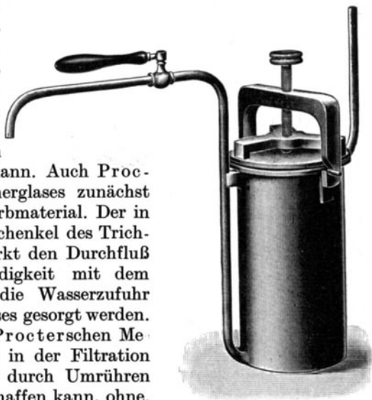
Abb. 32. Auslaugeapparat von Körner.
