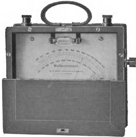
Fig. 59. Dynamometrischer Wellenmesser von G. Seibt.
