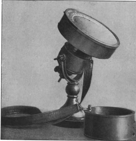
Fig. 53. Selbsttätig anzeigender Wellenmesser nach Hirsch.
