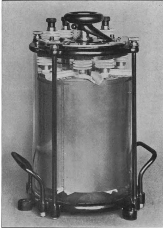
Fig. 19. Senderdrehkondensator mit senkrechten Platten in Öl (H. Boas, Berlin).
