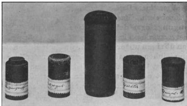
Fig. 176. Abbrand der Kohlen eines Lichtbogengenerators in Wasserstoff, Leuchtgas, Spiritusdampf, Schwefeläther.
