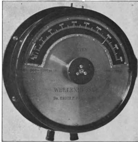
Fig. 52. Selbsttätig anzeigender Wellenmesser nach Hirsch (Dr. E. Huth, G. m. b. H., Berlin).
