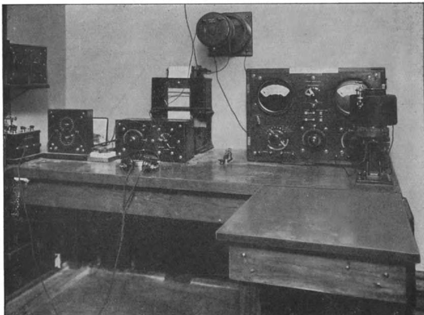
Fig. 283. Einrichtung für Schwebungsempfang mit Poulsenlampe, der National El. Signaling Co., Pittsburg, Virginia.
