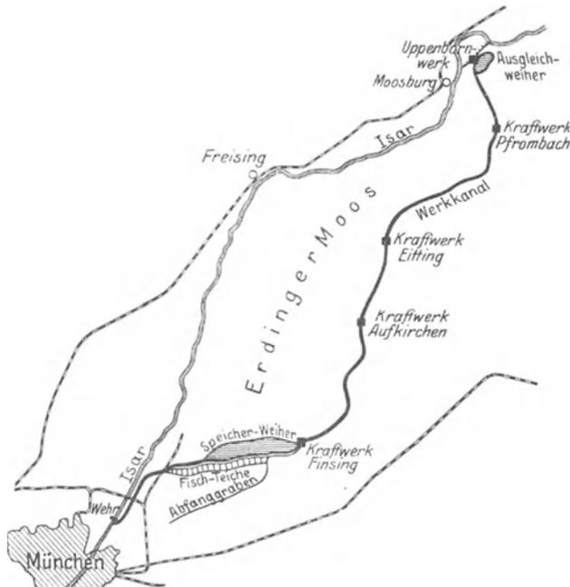
Abb. 38. Übersichtsplan der Anlagen der Mittleren Isar.
