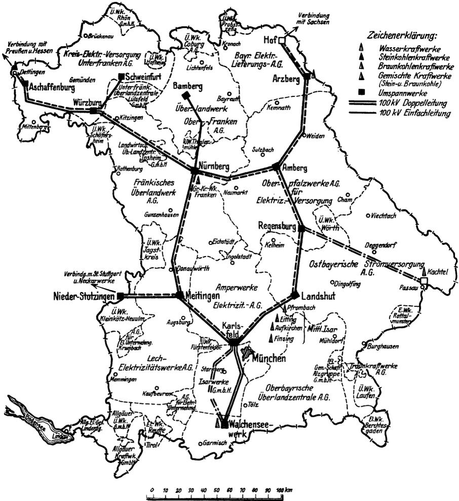
Abb. 40. Netzplan des Bayernwerkes. Führung der 100-kV-Leitung (Bayernwerk).
