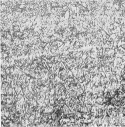
Abb. 98. Mat. 4. Probe wie Abb. 91. 500 Stdn. bei 100° C und 100 Stdn. bei 120° C gealtert. X 500.
