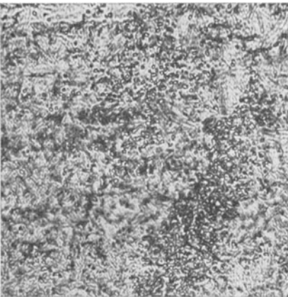
Abb. 92. Mat. 4. Probe wie Abb. 91. 500 Stdn. bei 100° C und 20 Stdn. bei 120° C gealtert. X 500.
