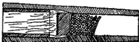
Рис. 119. Гильза коротка-прорыв газов
