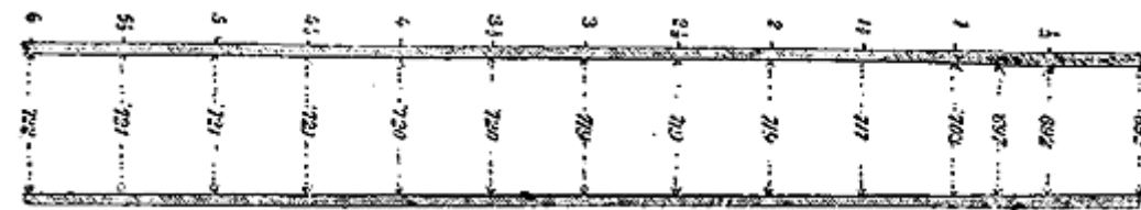
Рис. 46. Чок-бор с расширением перед ним
