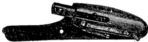
Рис. 75. Замок бескурковки Вудварда
