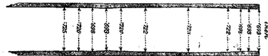
Рис. 46. Чок-бор с расширением перед ним
