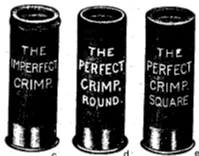
Рис. 125. Закрученные гильзы: с - плохо, д и е - хорошо
