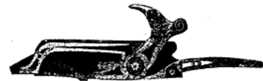
Рис. 91. Замок бескурковки Вестли Ричардса
