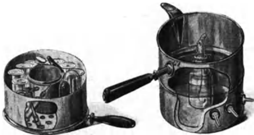
Abb. 49. Wasserbad mit herausgenommenem Einsatz. (Nach Seidel.)
