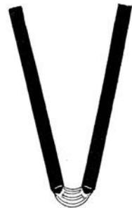
Fig. 239. Lichtbogen bei schräg nebeneinander angeordneten Kohlen.
