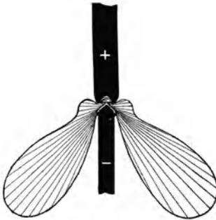
Fig. 234. Lichtverteilung eines Gleichstromlichtbogens.
