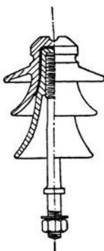
Fig. 251. Hochspannungs-Stützisolator.
