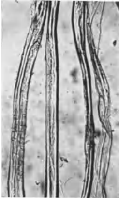
Abb. 36. Baumwollfasern unter dem Mikroskop.
