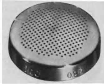
Abb. 234. Spinnbrause der Firma Friedrich Eilfeld, Gröbzig.
