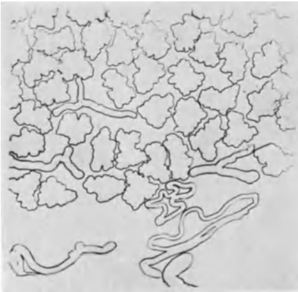
Abb. 152. Querschnitt durch einen Faden mit lufthaltigen Einzelfädchen.
