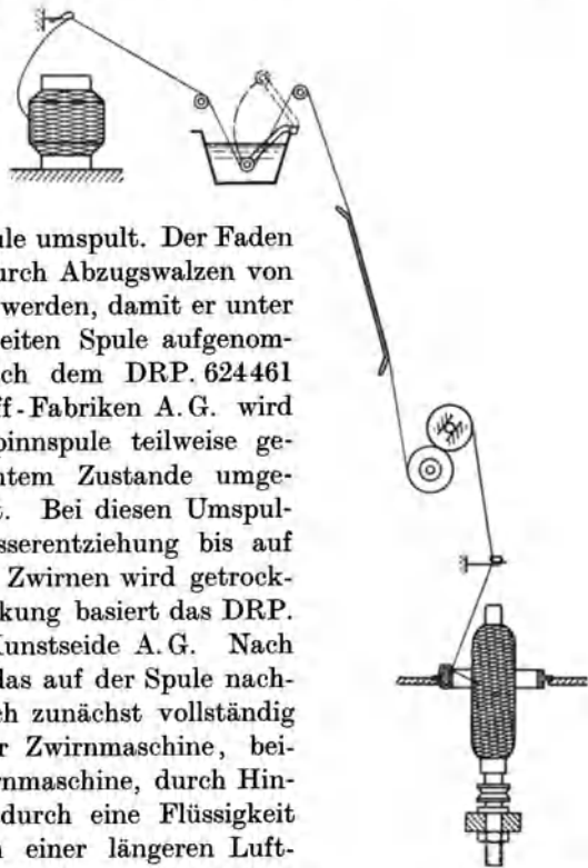
Abb. 328. Zwirnen gefeuchteter und erneut getrockneter Kunstseide nach DRP. 660614.
