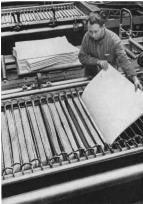
Abb. 111. Einsetzen der Zellstoffblätter in die Tauchwanne 1 .
