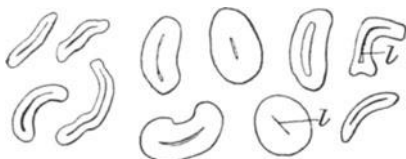
Abb. 37. Querschnitte durch Baumwollfasern. l Lumen.
