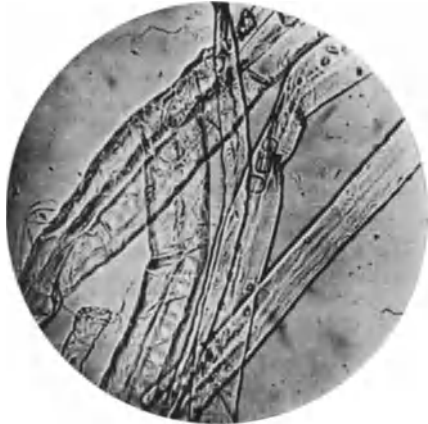
Abb. 62. Faserzellen im Kiefernholz Zellstoff.
