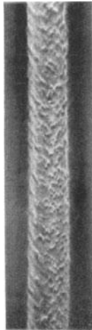
Abb. 339. Floxalanfaser unter dem Mikroskop.
