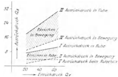
Abb. 107. Die Beziehungen zwischen dem Einrück- und dem Ausrückdruck nach Versuchen des Verfassers.
