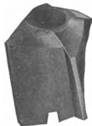
Abb. 91. Mit Vorrichtung geschliffener Senker.
