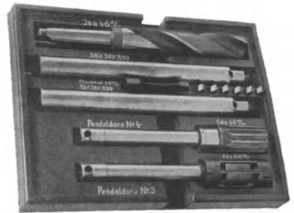
Abb. 194. Bohrsatz auf Brett.
