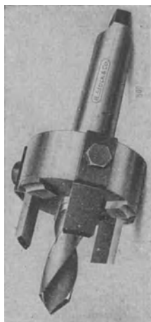
Abb. 67. Kesselbodensenker mit Bohrer.
