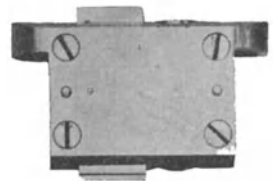
Abb. 122. Einbaureibahle mit pendelnden Messern.
