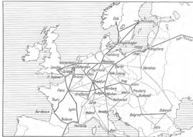
Abb. 7. Die Bodenorganisation des Luftlinienetzes Europas im Jahr 1934. ——— Befeuerte Strecken für Tag- und Nachtverkehr. ——— Strecken nur für Tagverkehr.
