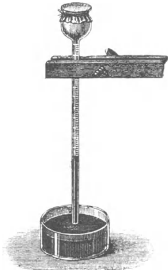
Fig. 89. Verdunstung des Wassers durch eine Membran, wodurch ein Steigen des Quecksilbers in der Röhre hervorgerufen wird.
