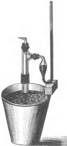
Fig. 85. Messung der Wurzelkraft. (Nach Pfeffer.)
