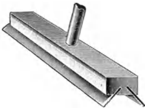
Abb. 72. Gummischieber. In dem hölzernen Querbrett sind zwei fingerdicke Gummipiaten eingefügt.
