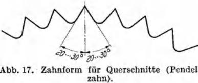
Abb. 17. Zahnform für Querschnitte (Pendelzahn).
