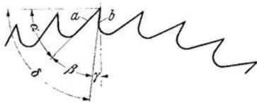
Abb. 15. Winkel und Flächen am Kreissägezahn.  $\alpha$  = Freiwinkel;  $\beta$  = Keilwinkel;  $\gamma$  = Spanwinkel;  $\delta = \alpha + \beta$  = Schnittwinkel;  $\alpha + \beta + \gamma = 90^{\circ}$ ;  $a$  = Freifläche (Rücken);  $b$  = Spanfläche (Brust). (Bezeichnungen entsprechend DIN 768 „Schneidstähle“.)
