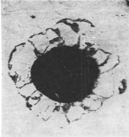
Abb. 276. Gefüge einer Kupfer-Silber-Legierung mit 6 Gew.-% Ag in der Umgebung eines Kegeleindrucks nach dem Ausglühen bei 800° C, Abschrecken und viertelstündigem Anlassen bei 420° C. [Nach H. BUMM u. U. DEHLINGER: Metallwirtsch. Bd. 15 (1936) S. 89.]
