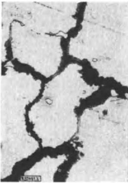
Abb. 273. Gefüge einer Kupfer-Beryllium-Legierung mit 2,3 Gew.-% Be (14,2 At.-% Be) nach dem Abschrecken und 22 min langem Anlassen bei 350° C (gegossene Probe). [Nach H. BUMM: Z. Metallkde. Bd. 29 (1937) S. 30.]
