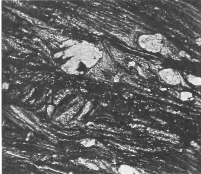
Abb. 10. Mylonit aus Granit. Helsinki, Finnland. 1 Nic. Vergr. 27×.
