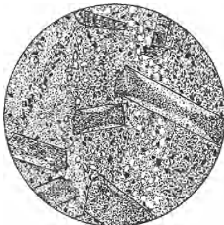
Abb. 11. Sanduhrförmig geordnete Einschlüsse von Graphit in Chloritoid. (Nach HARKER.)
