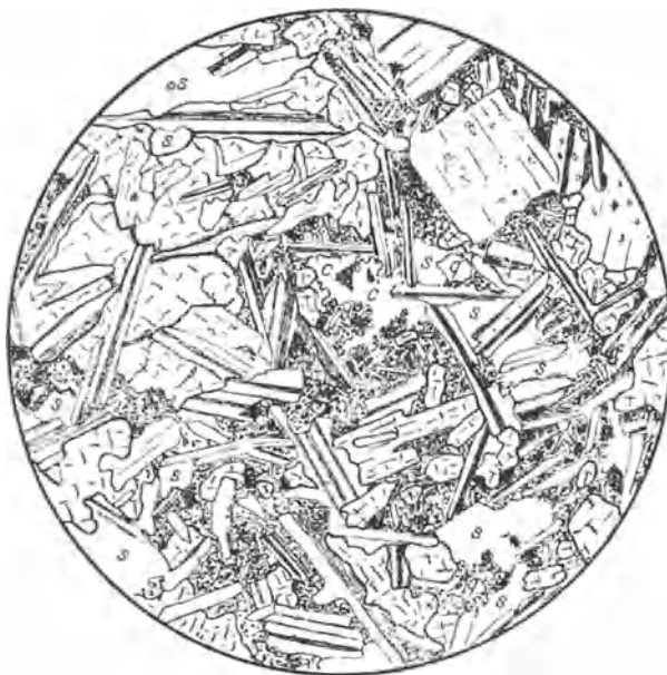
Abb. 64. Klinopyroxensplit mit erhaltenem ophitischen Gefüge. Solomen bei Petrosavodsk, Ostkarelien. Vergr. 36\times . s Serpentin; c Kalzit; q Quarz.
