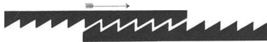
Abb. 134. Schema zur Veranschaulichung des „Sperrungs“-mechanismus. Das obere Stück kann in der Richtung des Pfeiles fortbewegt und die Gesamtlänge des Modells auf diese Weise verkürzt werden. Das obere Stück kann aber nicht wieder zurückbewegt werden, wenn die beiden Stücke nicht voneinander um die Höhe eines Zahnes abgehoben werden.
