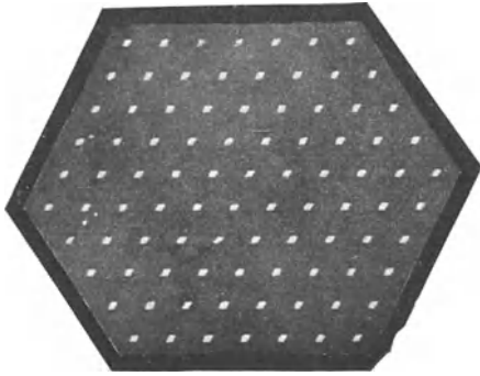
Abb. 8. Richtiges Bild eines Schnittes von ABBÉ'S Beugungsgitter. Photographiert mit Leitz' apert. \frac{1}{16} , Ölimmersion, Okul. 4. Powell- und Lealand-Kondensor, volle Öffnung der Irisblende.
