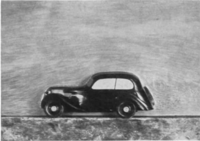
Abb. 102. Aufnahme von Strömungsbildern in Wasser.
