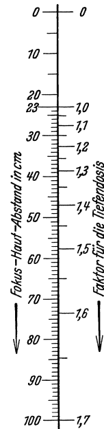
Abb. 38. Einfluß des Fokus-Hautabstandes auf die Dosis in 10 cm Tiefe.
