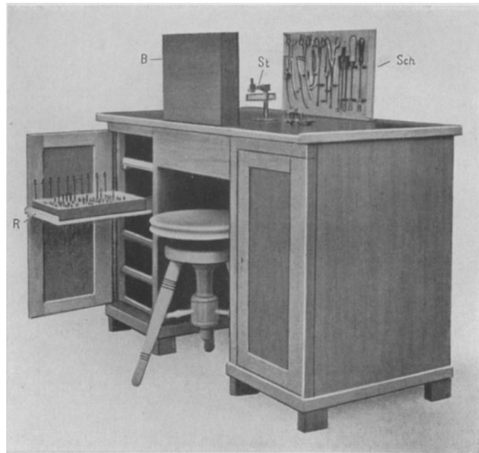
Abb. 98. Radiumarbeitsstisch mit Strahlenschutz (Universitäts-Frauenklinik Würzburg).
