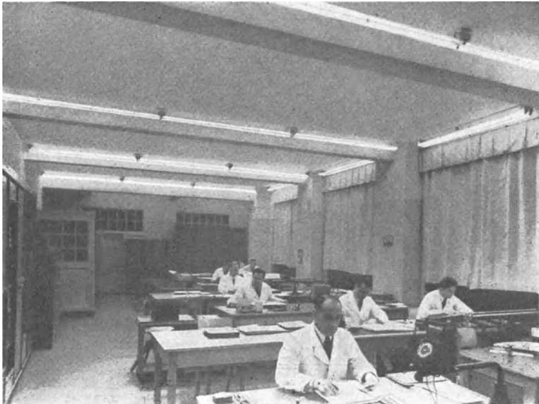
Abb. 7. Zeichensaalbeleuchtung mit tageslichtweißen Hochspannungsleuchtstoffröhren.
