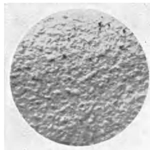
Abb. 16. Lichtbild einer durch Besprühen aufgetragenen Oxydschicht mittlerer Kristallgröße ( $\approx 10 \mu$ ).
