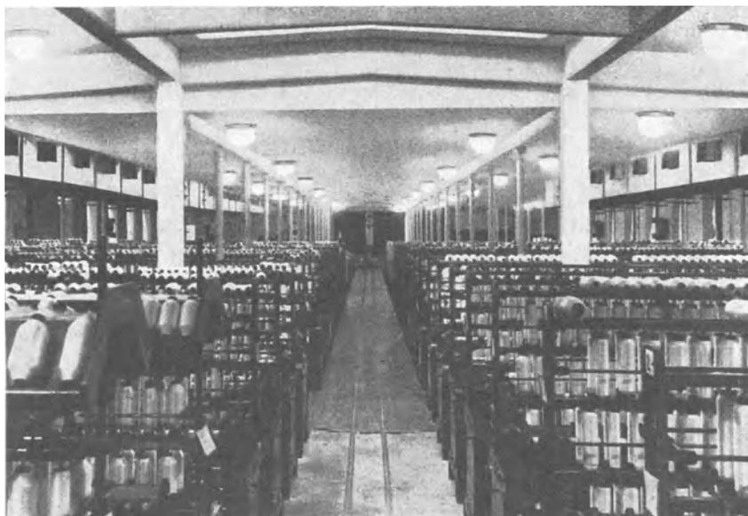
Abb. 2. Mit Mischlicht beleuchteter Maschinensaal einer Spinnerei, die schlecht mit Tageslicht versorgt ist.
