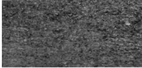
Abb. 7. Schnitt durch eine Torfoleum-Leichtplatte (1 : 1).
