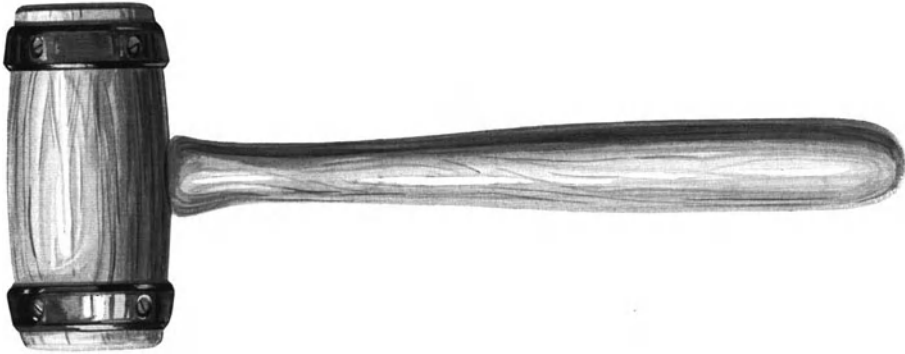
Abb. 1. Holzhammer mit Metallfassung.
