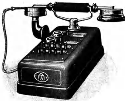
Abb. 342 a. Janusreihenstation für ZB-Betrieb mit 2 Amtsleitungen und 10 Nebenstellen, in Blechgehäuse.
