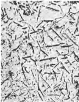
Abb. 43. Stickstoffnadeln (Nitritnadeln) in einer Lichtbogenschweißung.
