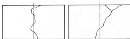
Abb. 15. Restkörper nach Biegungsbeanspruchung. Bruchverlauf auf der gezogenen Seite. Versuch B. 2. Mattkohle. Versuch B. 4. Streifenkohle.
