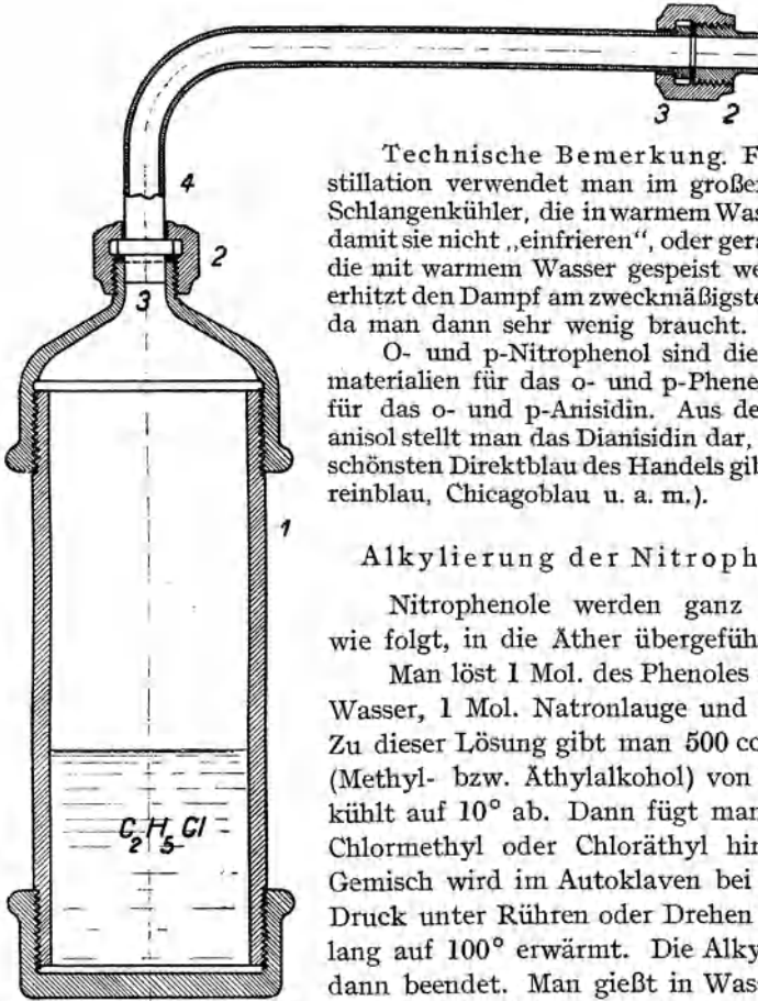
Abb. 16b. Hilfsbombe aus Gasrohr zum Einfüllen von Chloralkylen.
