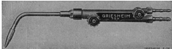
Abb. 25. Schweißbrenner für Azetylen. (Griesogen G. m. b. H., Frankfurt a. M.)
