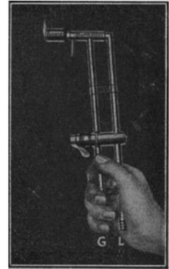
Abb. 15. Gebläsebrenner mit Hahn. (Bornkessel G. m. b. H., Berlin.)
