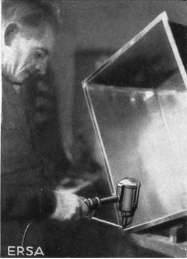
Abb. 54. Löten einer Blechnaht.
