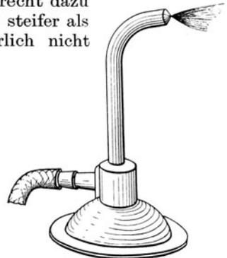
Abb. 22. Flachbrenner mit waagerechter Flamme. (Werkstätte f. Chemie u. Phot., Berlin.)
