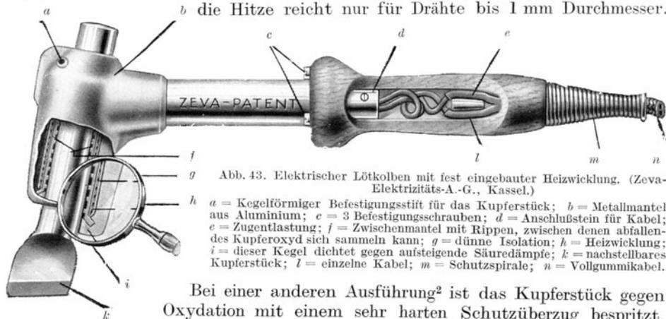
Abb. 43. Elektrischer Lötkolben mit fest eingebauter Heizwicklung. (ZeVA-Elektrizitäts-A.-G., Kassel.)
